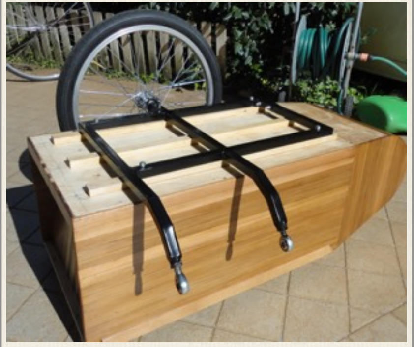
telaio con le staffe per la ruota e l'aggancio
