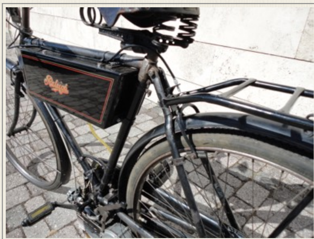
particolari freno posteriore modificato e serbatoio sottocanna
