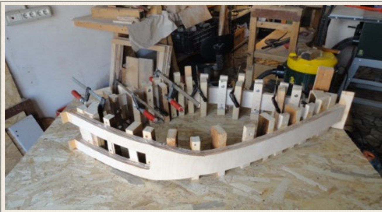
ultimo incollaggio di sagome di compensato su dime
